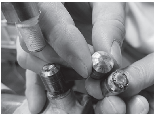
写真3 チップの汚れの比較。めっき被膜が剥がれ落ち、汚れとなる
