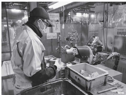
写真2 サーボガンスポット溶接機での加工。スパッタが原因の火花は、加工する作業者にとっても危険だった
